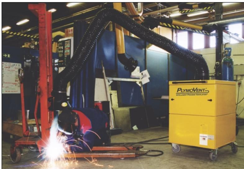
*¡El brazo de extracción PlymoVent gira 360° sobre el filtro, alcanza a todas partes!*
